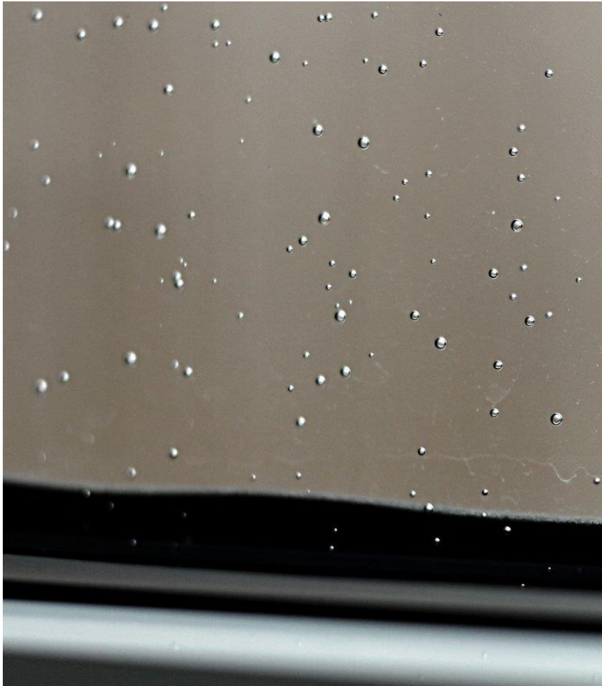
Detailní výskyt bublinek v ploše tabule z protipožárního skla
